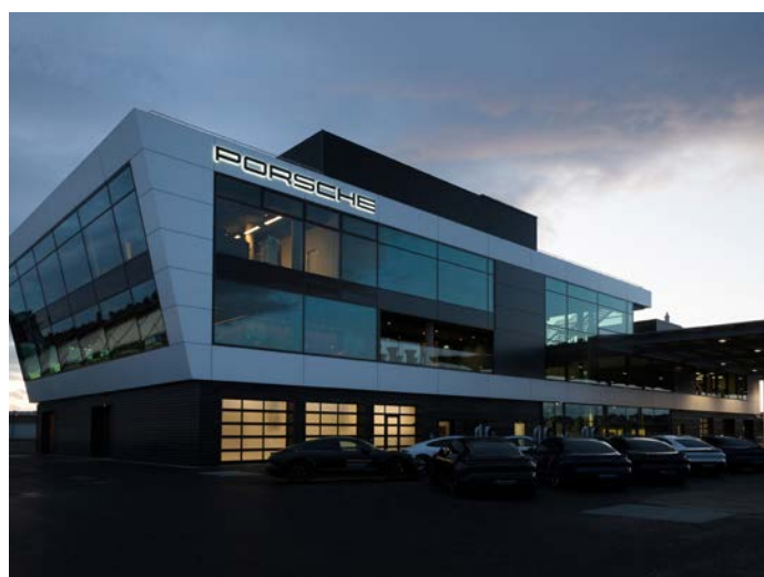
Abb.: Die Ausleuchtung des Porsche-Schriftzugs erfolgt mittels weißer LED-Module mit nach hinten gerichteter Lichtabstrahlung. Bei nächtlicher Beleuchtung wirken die Buchstaben schwebend.
